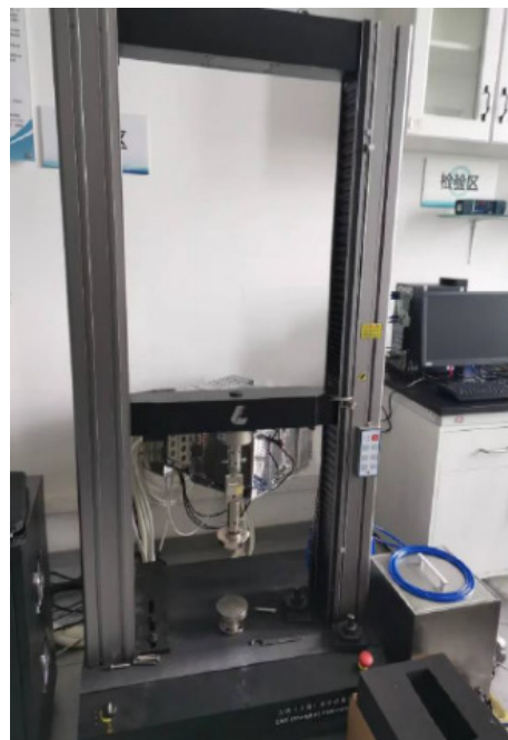
图 10 电子万能试验机测试装置
