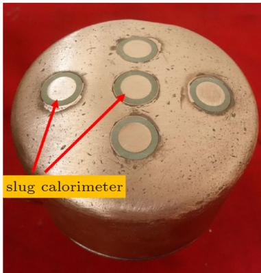
图 12 等热流测试模型及塞式量热计
