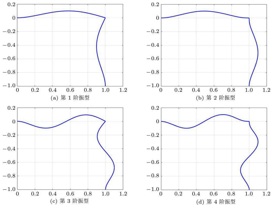
图4 模态综合法计算的前4阶振型
