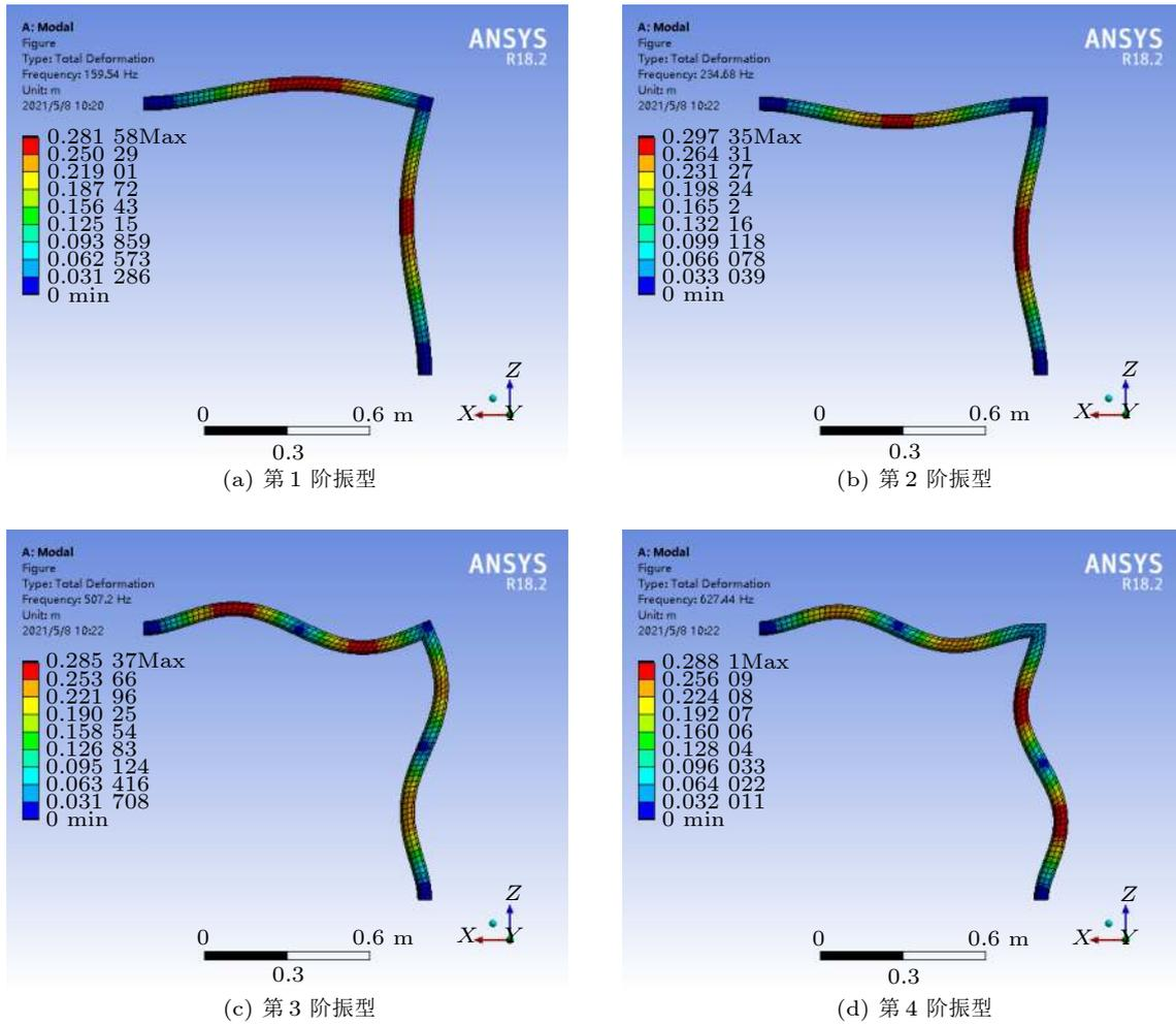
图 3 有限元计算的前 4 节振型
