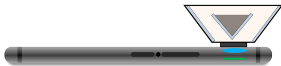
(c) 已建立的基于智能手机的3D-DIC系统的示意图
