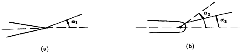
图1 裂尖形状及其启裂和扩展方向的定义
